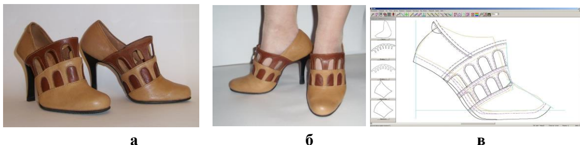
Рис. 9. Разработанная авторская модель (а); апробация готовой модели (б); конструктивная основа деталей верха обуви в программе АСКО -2Д (в)
